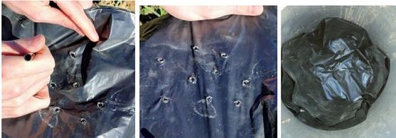
3. Déposer le sac plastique troué à l'intérieur du cylindre à la surface du sol pour éviter l'effet "splash" quand l'eau va être versée
