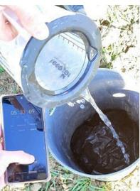
5. Verser une dose de 310mL dans le cylindre et commencer en **MÊME TEMPS** le chronométrage
