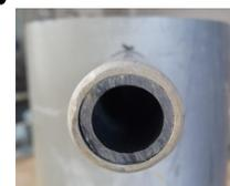
Percer un trou de chaque coté pour pouvoir insérer un tuyau qui facilitera l'extraction du cylindre à la fin du test
