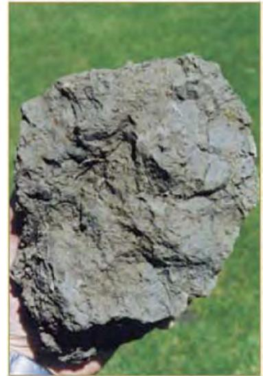
Les macropores ne sont pas visibles dans des mottes denses et compactes. Les mottes présentent des faces plutôt lisses avec des arrêtes plutôt anguleuses
