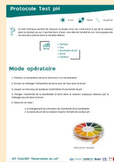
Mesure au champ du pH de la solution d'un sol par bandelette pH
